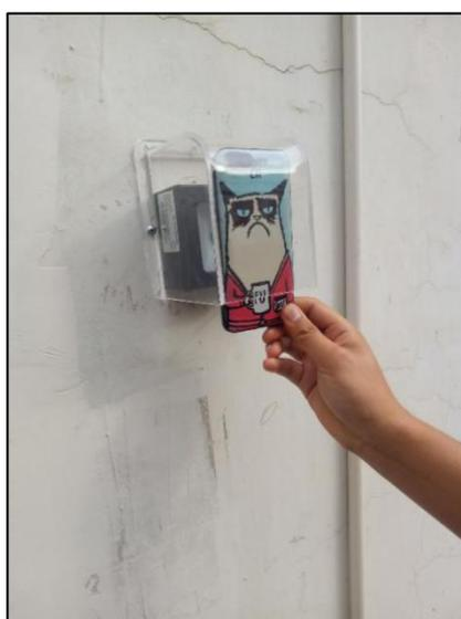
正常情况下可直接把手机贴在防雨罩上实现刷码门禁，若阳光强烈或灰尘影响防雨罩清晰，可把手机放入防御罩里实现刷码门禁。
